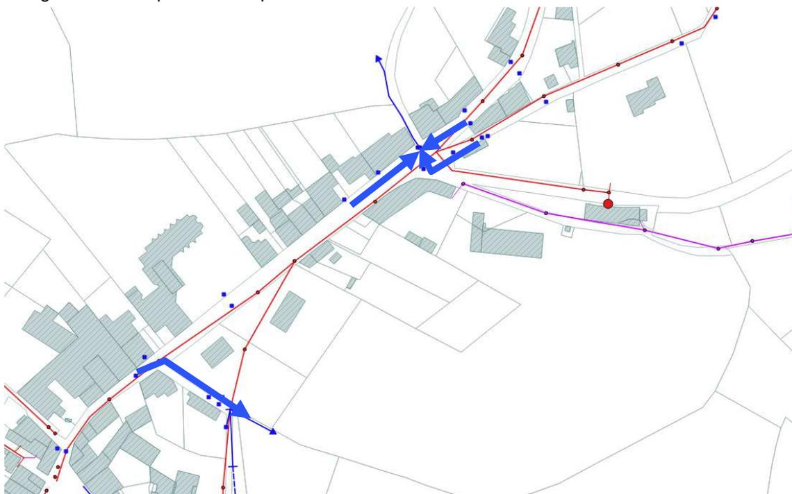
**Figure 5 : Situation des travaux pour le dé-raccordement d'eaux pluviales sur le réseau unitaire**
